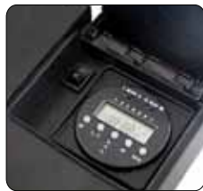
図19：ライトコントロールパネルの配置
